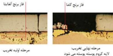
این مکانیسم تخریب پس از مدت های طولانی کاری در موقعی که خنکسازی به خوبی صورت نگیرد و بنابراین دمای قالب تا حد زیادی بالا باشد (مثلاً 300 تا 350 درجه سانتیگراد)، همچنین مقدار عنصر روی موجود در فولاد نیز بیشتر از 30 پی پی ام باشد رایج است. تصویر این مکانیزم تخریب را در شکل زیر مشاهده می کنید.
