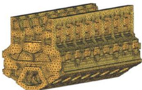
شکل ۱- مدل مش‌بندی شده بلوکه موتور لوکوموتیو.
