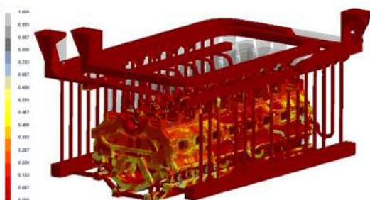
شکل ۲- نحوه پر شدن بلوکه موتور لوکوموتیو در ثانیه ۵۳.
