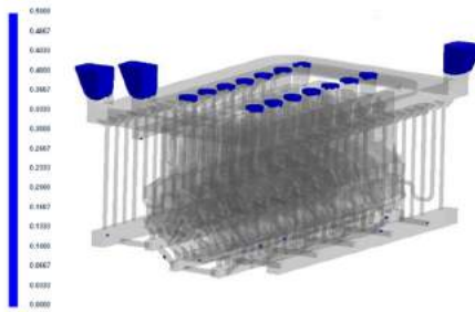
شکل ۳- حفره‌های اولیه به وجود آمده در پایان انجماد.
